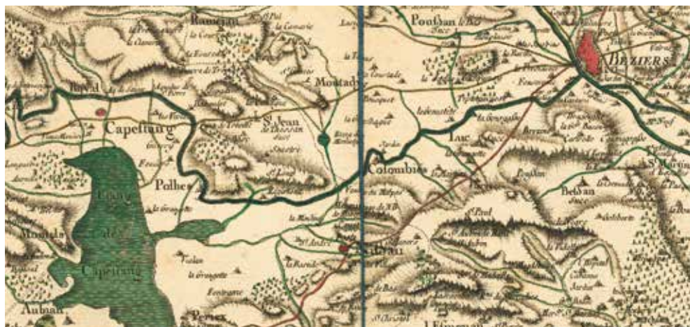
Fig. 35 - L'étang de Montady d'après la carte de Cassini (milieu du XVIII e s.). Le centre de l'étang est représenté en eau. Figurent aussi les fossés principaux et l'exhaure passant par la Mouline jusqu'à l'étang de Capestang.
