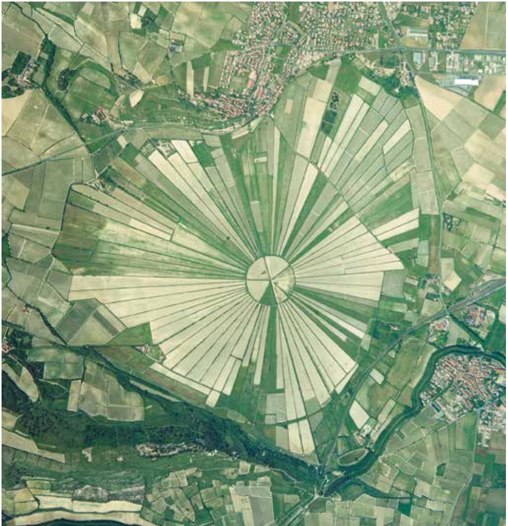
Fig. 11 – Le parcellaire de l'étang de Montady. La vue aérienne zénithale met en valeur le rayonnement des fossés et le fossé central circulaire (le redondel ). En haut (nord), le village de Montady, en bas, à droite, le village de Colombiers.
