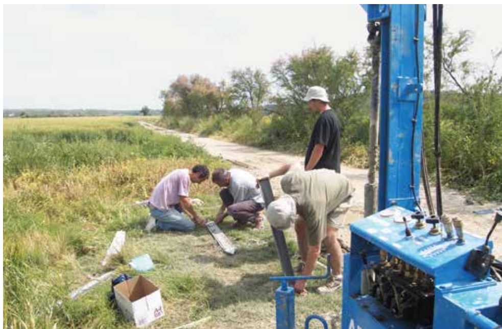
Fig. 13 – Carottage dans l'étang de Montady (2004) avec, de gauche à droite, J.-F. Berger, P. Blanche-manche, S. Rescanières et É. Dellong.
